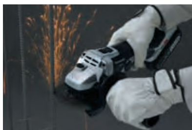
Taglio di barre di armature
