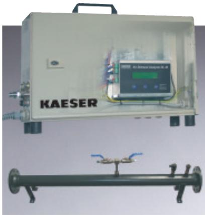
Fig. 2: Attrezzatura per la misurazione del consumo d'aria compressa. La portata viene determinata misurando la pressione differenziale con l'ausilio di un tubo introdotto nella rete in pressione.
